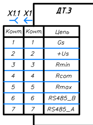
Рисунок 4 - Схема цепей разъема ДТ.3.01.XXX.07.02
