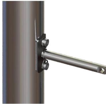
Рисунок 10: Кронштейн подвески ДП на штанге ДУ-М.
